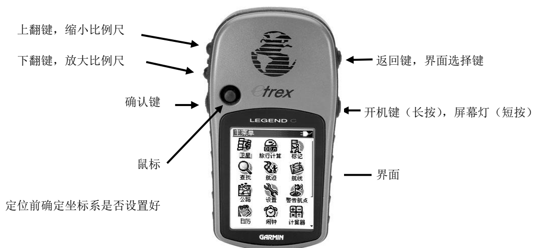
图 14-2 GPS 的按键的简要图示
